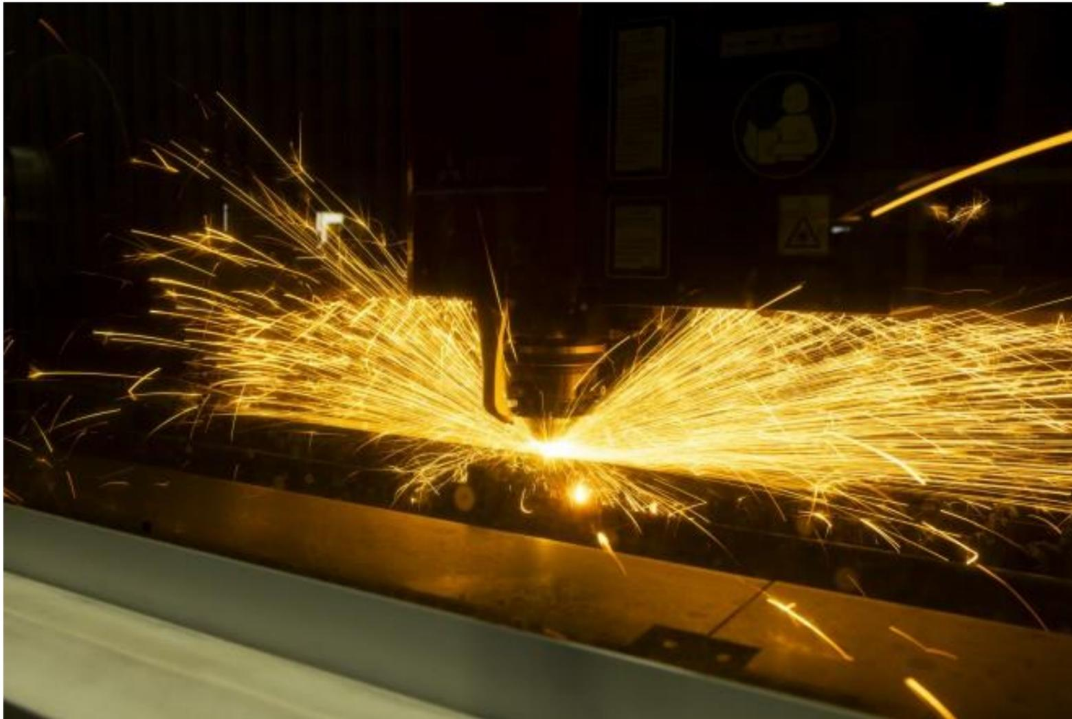
ファイバレーザは、光ファイバを媒質に用いた固体レーザです。
