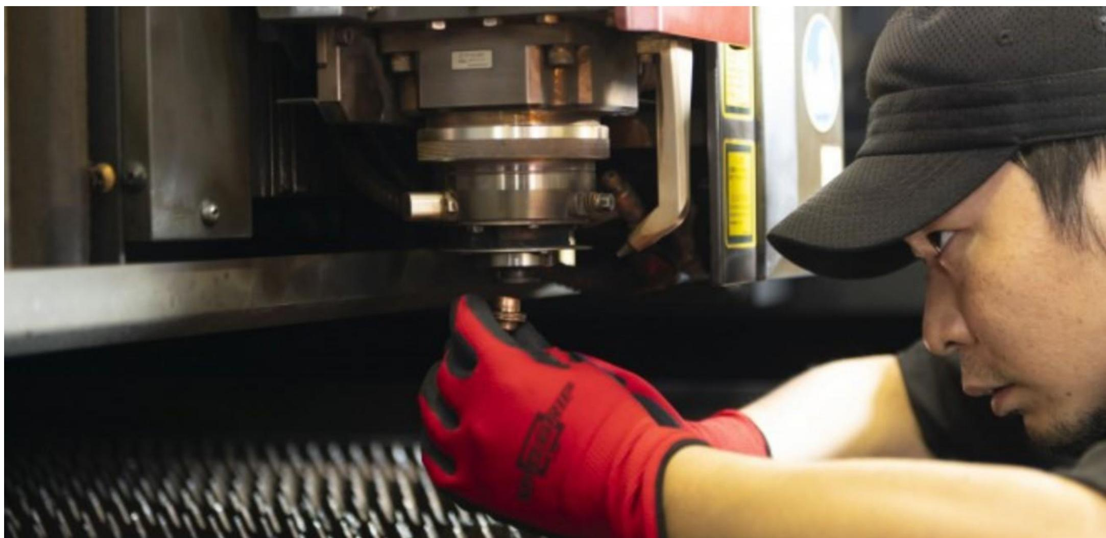
製缶板金加工では、明確な基準はありませんが、一般的には板厚7mm以上の鉄やステンレスなどの中厚板領域の加工が主となります。製缶板金加工業では、ビアス時のひげ、スパッタの飛散、加工時のバリ・反り（熱歪み）・焼け等の問題が起こることが多いです。
