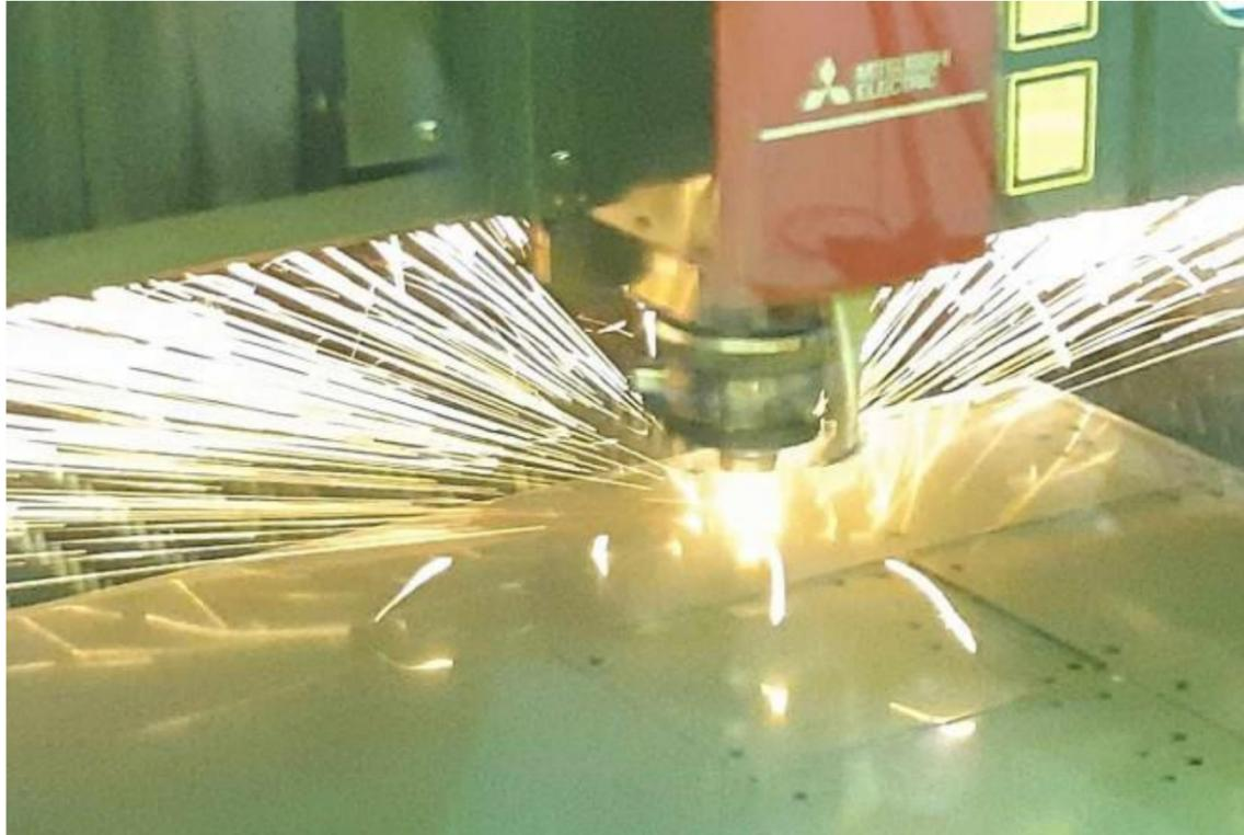
「自社製発振器」の投入により、信頼性、加工性能等の品質向上を実現しております。
