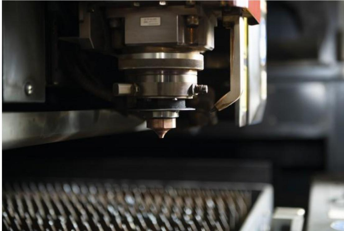
三菱電機独自の光学系技術を駆使した自社製加工ヘッド「Zoom Head」により、**材質、板厚に応じてビームを最適に制御**します。その際、ビームモードも最適なモードに変更します。それにより、加工条件の選択の幅が拡大され3つの効果を発揮します。
