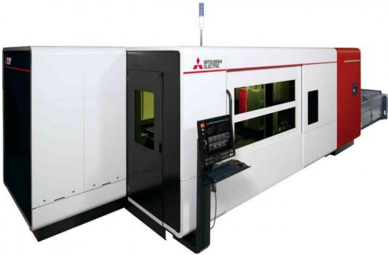
「GX-Fシリーズ」にはダイナミックFC（Dynamic Focus Control）機能が搭載されています。レーザ加工機に世界初のAIを搭載していましたが、さらに**止まらない加工機を追求するための新機能**です。レーザ加工機の加工不良の要因の一つとして「熱レンズ」があります。その熱レンズが発生した際に、自動で焦点位置を最適化することで、加工の安定化を実現しております。焦点変動幅を緩和することにより、**連続加工中の加工不良発生・品質低下を予防**できます。
