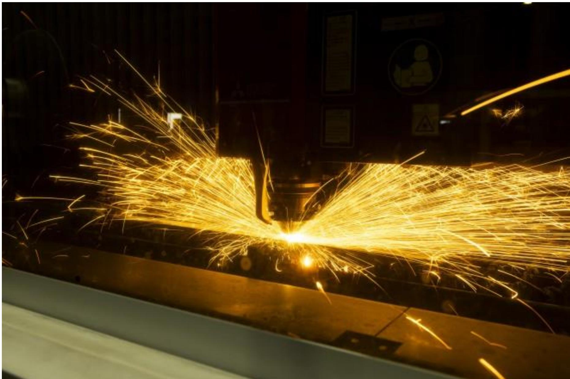
ファイバレーザは、光ファイバを媒質に用いた固体レーザです。銅やアルミニウムのような**溶接が難しい素材でもピンポイントに熱を加え、溶かす**ことができます。ファイバレーザ加工機は、レーザ加工機の中で最も歴史が浅く、CO<sub>2</sub>レーザ加工機の弱点を補う特徴があります。
